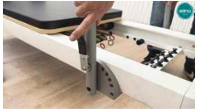
Para colocar la barra de pies, presionamos la pestaña de ajuste de posición y la colocamos en el deseado.
