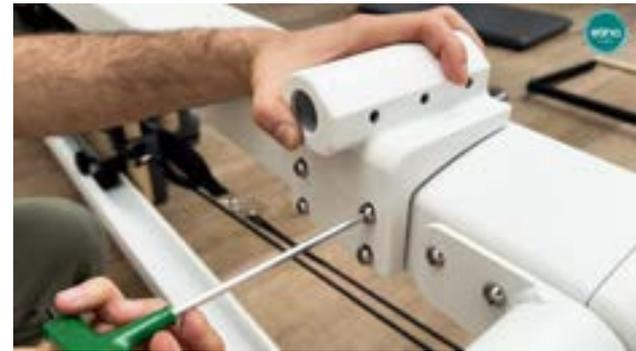
Wir beginnen mit der Platzierung der Metallteile, die den Turm auf der Struktur stützen. Die Unterlegscheibe muss an der Innenseite des Reformers angebracht werden, im langen Teil.
