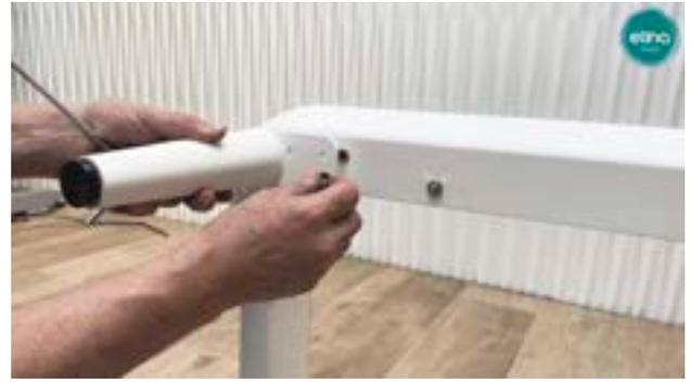
Para colocar las patas, desenroscamos las que vienen preinstaladas en el reformer. Colocamos las patas sin ruedas en el cabecero del reformer.
