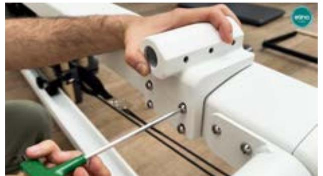
Nous commençons par placer les pièces métalliques qui soutiennent la tour sur la structure. Nous devons placer la rondelle vers l'intérieur du reformeur, dans sa partie longue.
