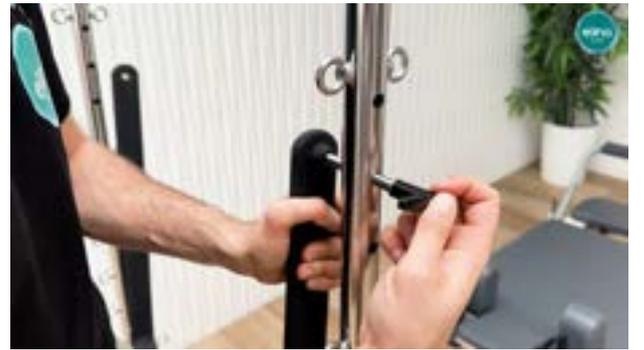
Nous plaçons la barre de poussée sur la tour, en insérant les ancrages de fixation depuis l'extérieur.
