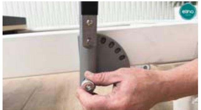
Fijamos la barra utilizando los tornillos de ajuste provistos, como se puede observar en la imagen.
