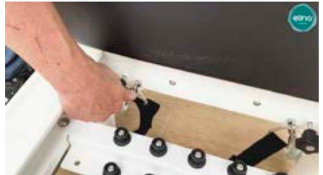
Insérez la planche à sauter dans les trous indiqués et serrez-la à l'aide des molettes de réglage pour la fixer correctement.
