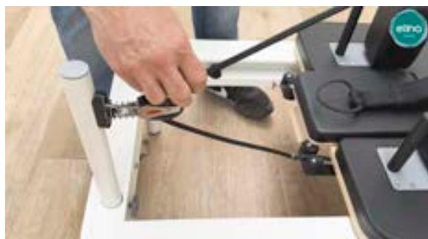
Insérez les cordes dans les poulies, en commençant par faire passer l'extrémité libre dans la poulie. Ensuite, nous passons la corde dans les vis de réglage désignées pour régler la longueur de la corde.
