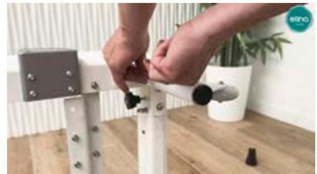
Les pieds à roulettes sont placés sur le fond du reformeur, en veillant à ce que les roulettes soient orientées vers l'extérieur. Fixez les pieds de la même manière.
