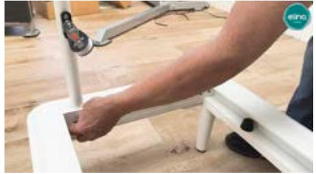
Wir setzen die Umlenkrollen ein und befestigen sie mit den Einstellrädern so fest wie möglich.
