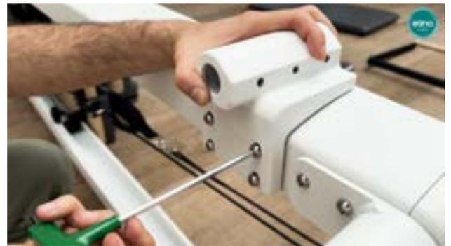
Comenzamos colocando en la estructura las piezas metálicas de soporte de la torre. Debemos colocar la arandela hacia el interior del reformer, en la parte larga del mismo.
