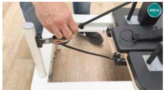
Führen Sie die Seile in die Umlenkrollen ein, indem Sie zunächst das freie Ende durch die Umlenkrolle führen. Anschließend wird das Seil durch die vorgesehenen Stellschrauben geführt, um die Länge des Seils zu regulieren.
