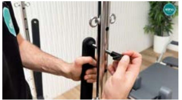
Colocamos la push bar en la torre, introduciendo los anclajes de sujeción desde el exterior.
