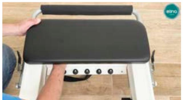
Nous plaçons le marchepied dans le même trou que la planche à sauter et le fixons à l'aide des roues de réglage.
