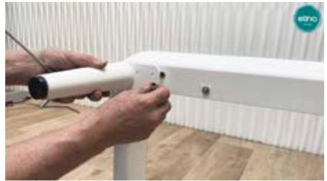
Um die Beine zu montieren, schrauben Sie die am Reformer vorinstallierten Beine ab. Setzen Sie die Beine ohne Räder auf das Kopfteil des Reformers.
