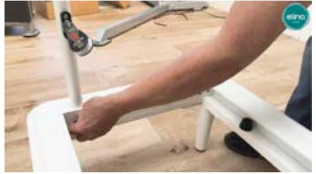
Encajamos las barras de poleas y las sujetamos al máximo utilizando las ruedas de ajuste.
