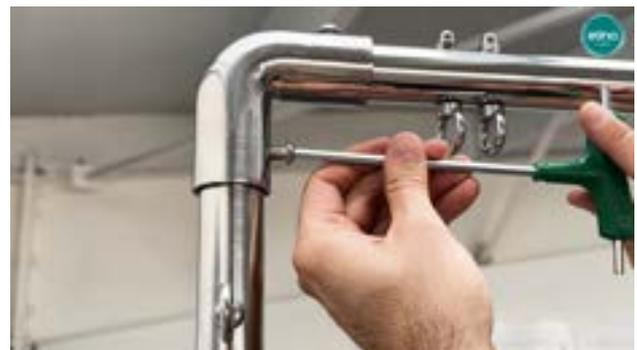
Wir setzen die langen Stäbe in die Metallstrukturen ein, die wir umspannt haben, und dann setzen wir die obere Metallstruktur, die als Brücke dient, ein und verschrauben sie.
