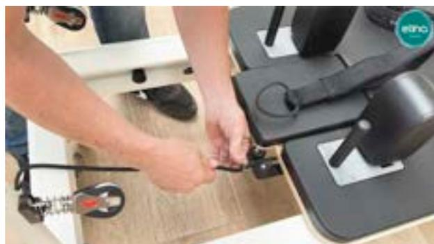
Nous utilisons le système de corde rétractable pour ajuster facilement la longueur souhaitée de la corde, car elle se rétracte automatiquement. Il suffit de la tirer et de la laisser à la longueur souhaitée.
