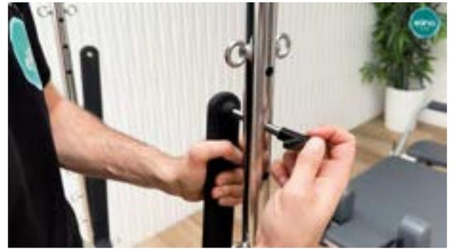
Wir setzen die Schiebbestange auf den Turm und stecken die Befestigungsanker von außen ein.
